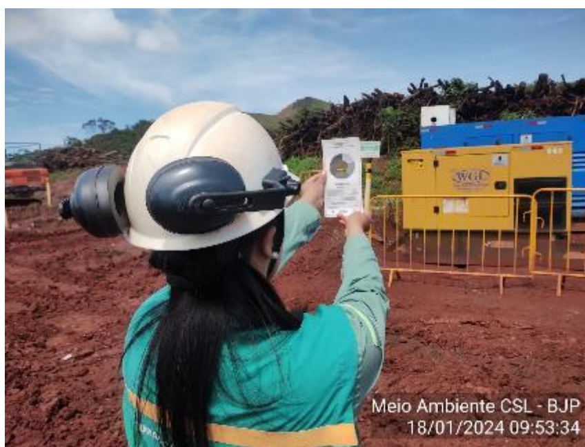
Foto 21 Monitoramento de fumaça preta com base na escala Ringelmann
